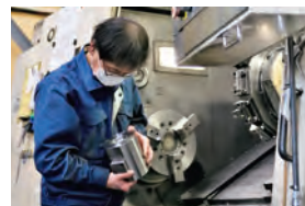
空調の強制対流で温度を均一化し、工場内に最適な仕上げ環境を作っている。
